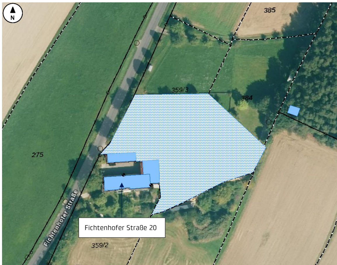
Abbildung 2: Auslegung Flächenschallquelle nach DIN 45691 für den Betrieb Holzbau Kiener GmbH
